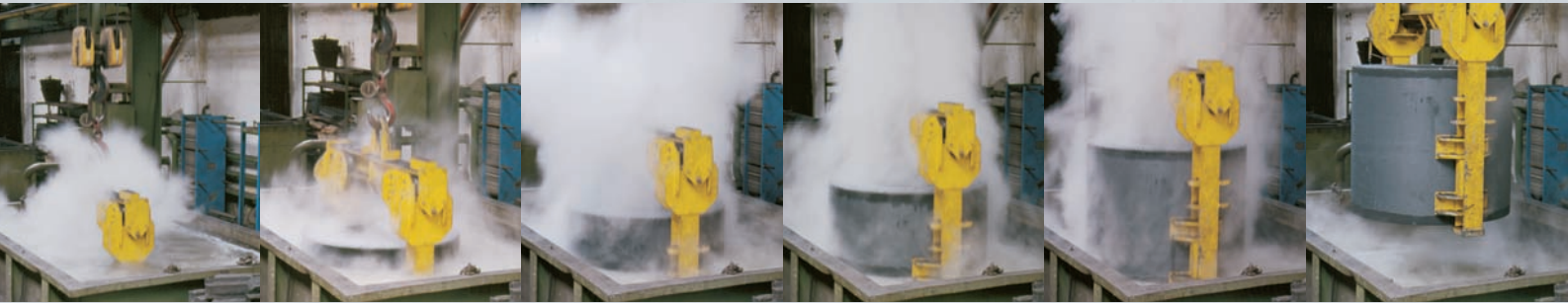
Abschrecken von Rezipientenmänteln im Polymerbecken
