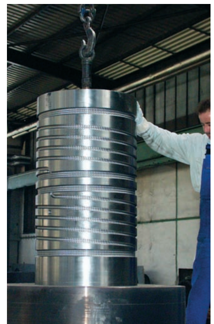
Einschrumpfen einer gekühlten Zwischenbüchse in vorgewärmtem Mantel
