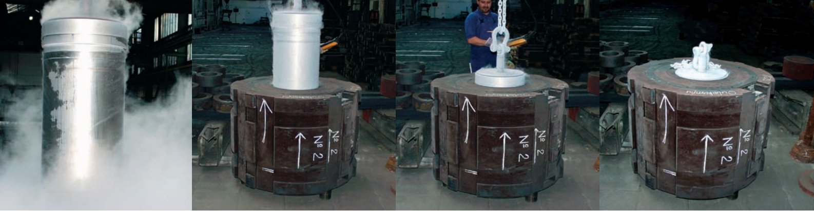
Unterkühltes Einschrumpfen von Innenbüchsen mit Doppelschulter
