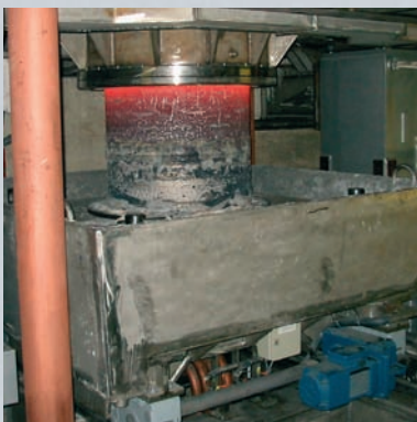
Gleittiegel mit absenkbarer Bodenplatte Short collar mold design with retractable base plate
